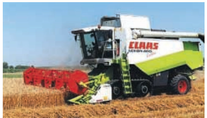
Mähdrescher mit Gummibandlaufwerk (Werkfoto Claas)
