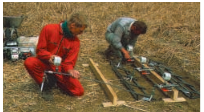
Ermittlung des Bodendrucks mittels Sonden (Würfel, Karlsruhe)
