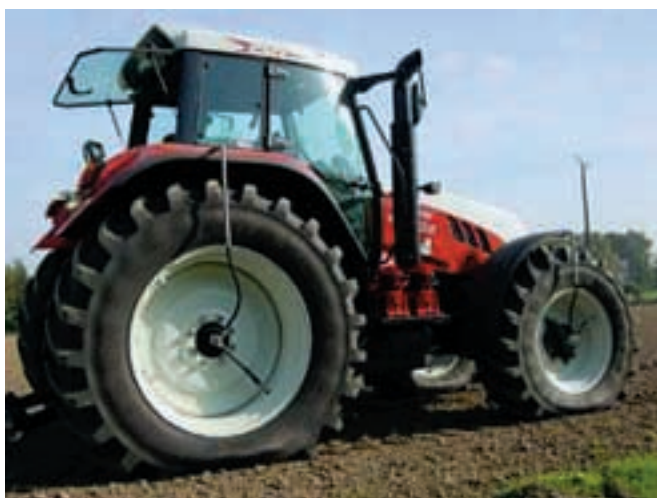
Schlepper mit Reifenregelanlage (Volk, Soest)
