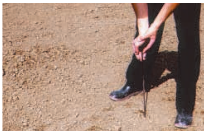
Mit der Bodensonde verschafft man sich einen guten Überblick über potenzielle Verdichtungen im Boden. (AID, Bonn)
